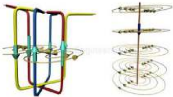
Gambar 1.1 Arus pada kumparan yang menghasilkan fluks. (Supriyadi, 2019)
